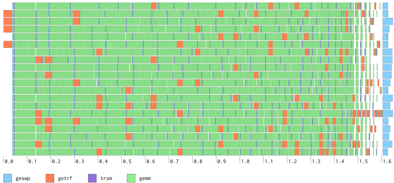
Figure 7.9: Trace of plasma.dgetrf() on POWER8: ./test dgetrf --dim=10000 --nb=336 --ib=32 --mtpf=4
